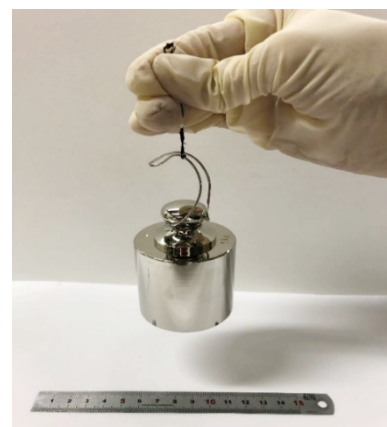
写真3 \Phi 0.4\text{mm} で1kgを持ち上げ可能
