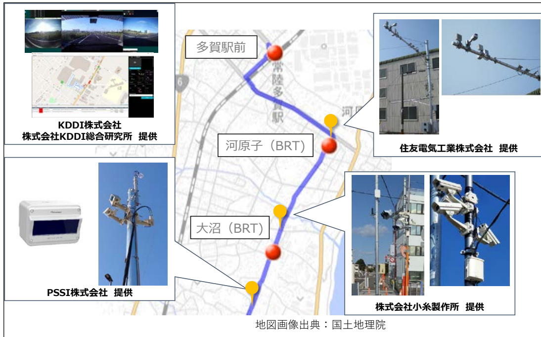
図 3. 路側センサーの設置個所と設置物
