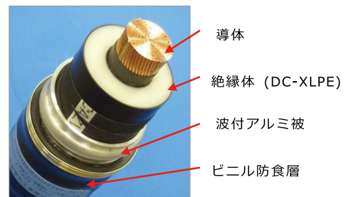
写真3 新北本ケーブル構造
