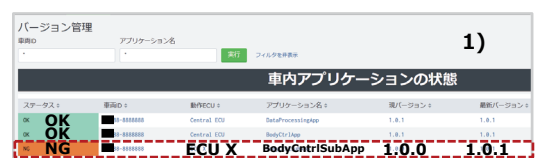
図9 システムはECU Xに搭載されているアプリケーションBodyCtrlSubAppのバージョンが最新バージョンでないこと検知する（図中破線部）。管理者は当該箇所をクリックして詳細を表示する。
