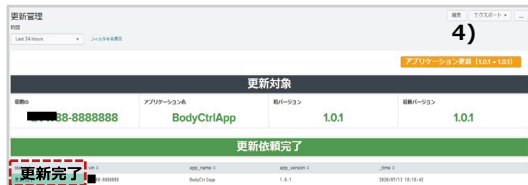
図 12 車両はシステムからの依頼を受け、当該アプリケーションの更新を行い、完了後システムに完了通知を発行する。画面上では状態が更新完了となる (図中破線部)。
