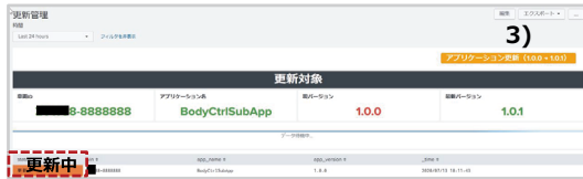
図 11 システムは管理者の指示を受け、車両に当該アプリケーションの更新指示を出す (OTA)。画面上では状態が更新中となる (図中破線部)。
