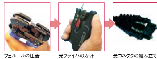
圧着カット式コネクタの組み立て(光コネクタCF-2071の場合)
