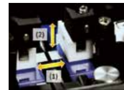
Active-ACAS (自動軸ズレ低減機能) TYPE-72M12に搭載
