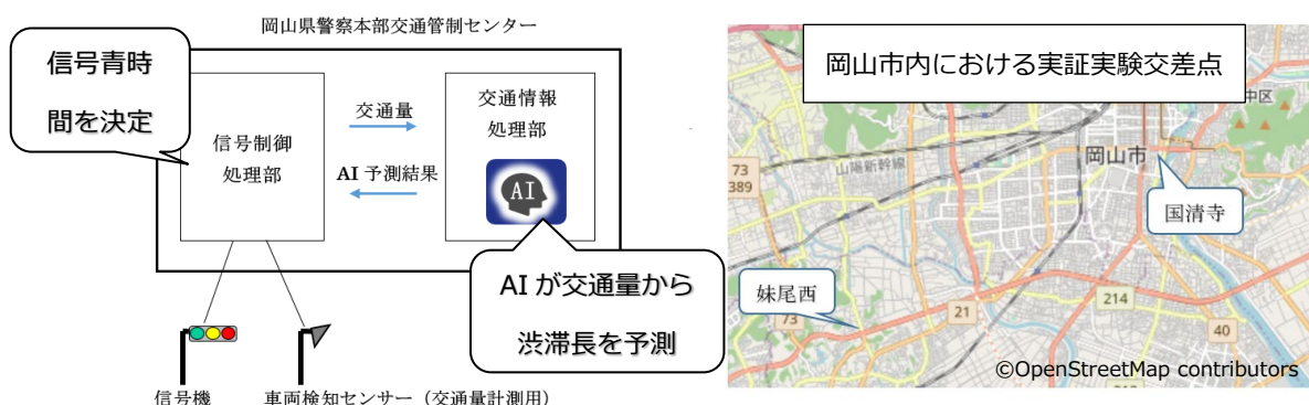
図2 フィールド実証実験システムの概要
