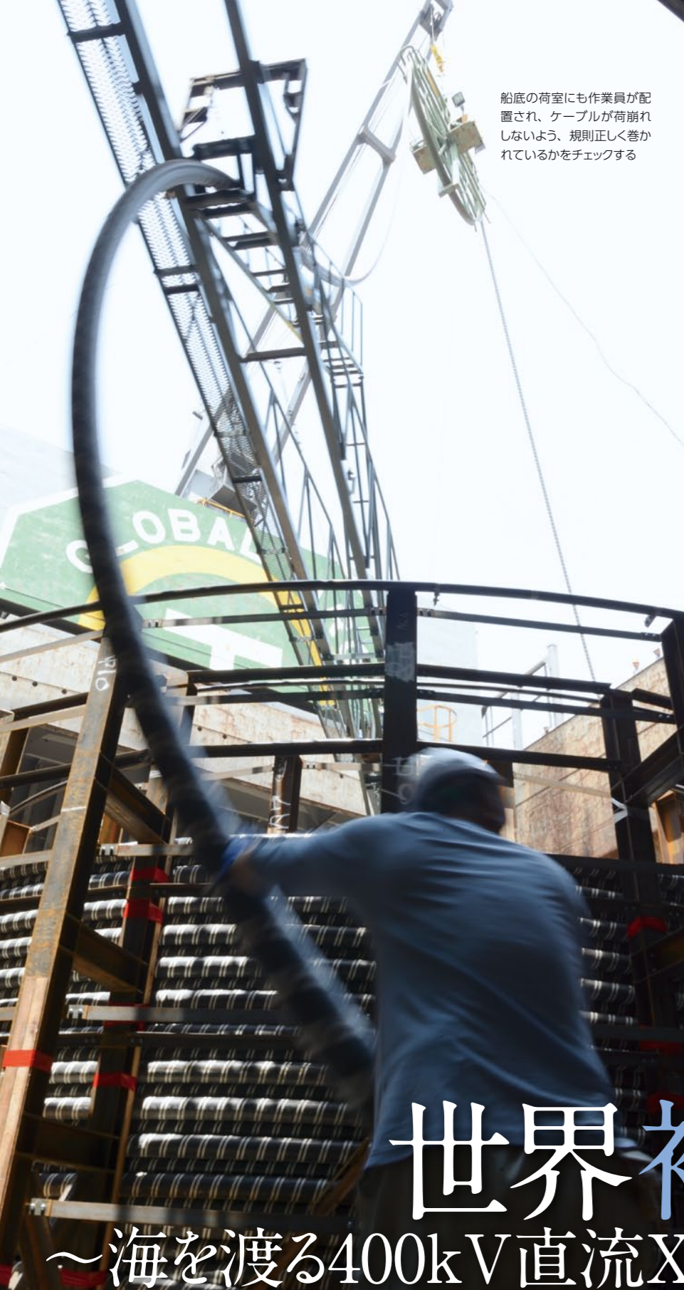
イギリスに向け出航した、400kV 直流 XLPE 絶縁ケーブルを載せた貨物船
