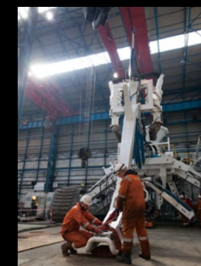
海底ケーブルを敷設するトレンチングマシン「T3200」
