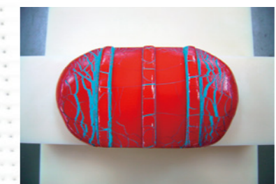
模擬圧着実験。電線に見立てた粘土を模擬端子で押しつぶすと、セレーション付近で大きく変形し塗膜が破れる。
