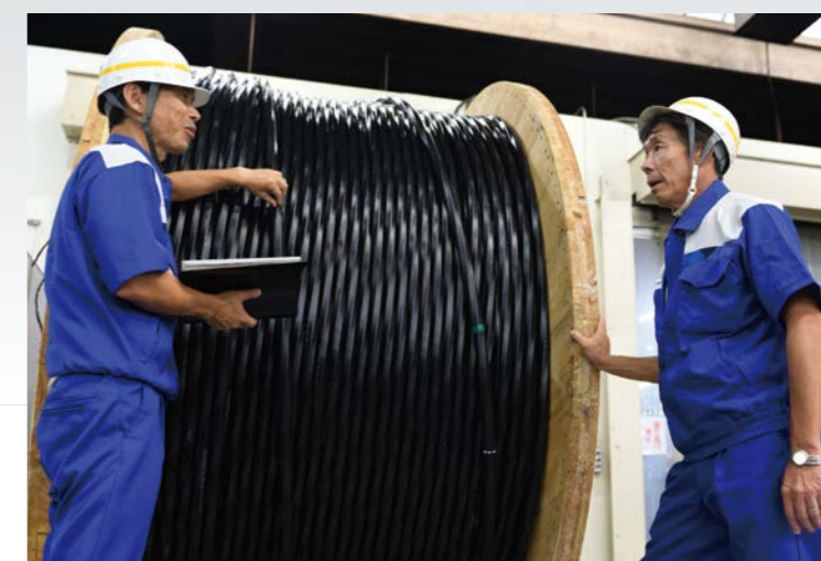
出荷を待つ「3456心ケーブル」(左:ケーブル製造部長 岡田武彦、右:技術部長 天野亜夫)
