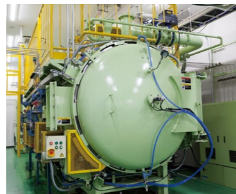
ZnSe(ジंकセレン)合成炉
