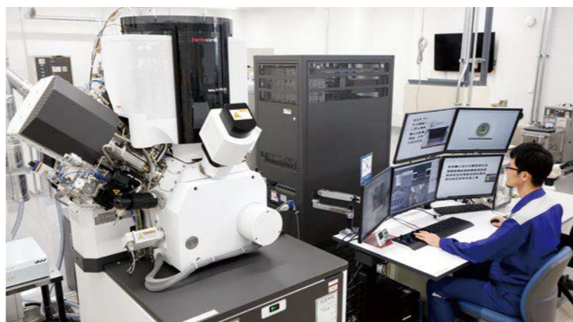
FIB-SEM / 集束イオンビーム・走査型電子顕微鏡複合機。断面加工・観察の主力設備
