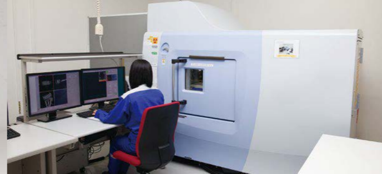
マイクロフォーカス X線CT装置。X線を用い非破壊で試料の内部構造を3次元的に観察
