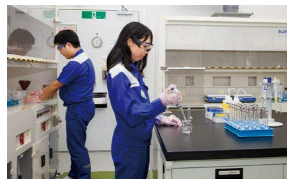
前処理。化学分析用にサンプルを溶かすノウハウが集約された作業
