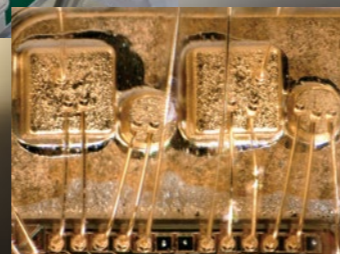
直径20μm程の極細金ワイヤを用いて部品間のワイヤボンディング
