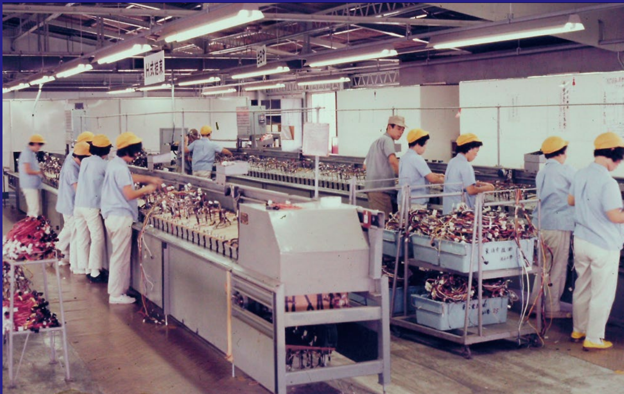
住友電装（株）狭山工場（1965年開設）ハーネス組立ライン
