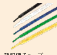
熱収縮チューブ(スミチューブ®) 過熱により内径方向に収縮するチューブで、電線・ハーネスの絶縁保護、防水、結束などに使用されます。
