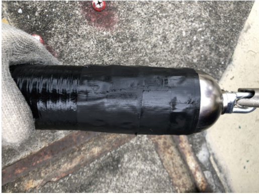
写真2 成端細径3456心ケーブルの耐久性試験後外観
