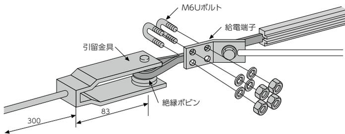
■折曲げた導体を引留金具の絶縁ボビンに巻付け、プライヤーなどで押さえ給電端子をM6Uボルトで締め付けます。
