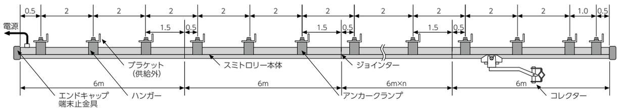
■ライン中央部にアンカークランプを取付けてください。
