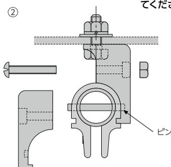
■2つ割りアンカークランプの片方を取付けてピンをスミトロジー本体に挿入します。
