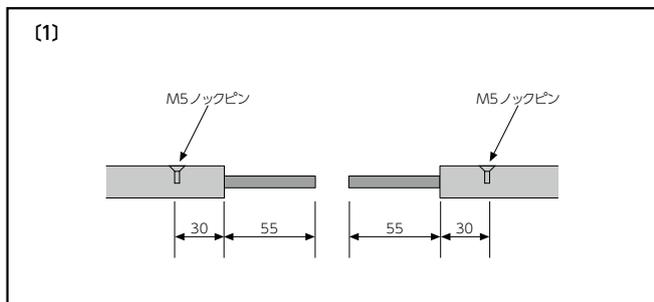
■本体の絶縁被覆を先端より55mm切断してください。
