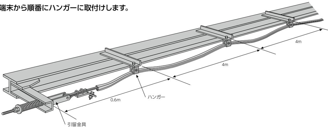
■端末から順番にハンガーに取付けした後、反対側の引留金具も同じ手順で取付けてください。
