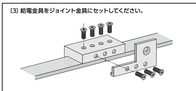
■ M6 ボルト上側4本と側面3本を締め付けて下さい。
