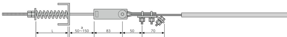
■ブラケットとの間隔aが狭すぎると、スミロングC本体が伸びた際に金具が当たりバネ力が利かなくなりますので、トロリー長さにより50~150mm以上開けて施工してください。
