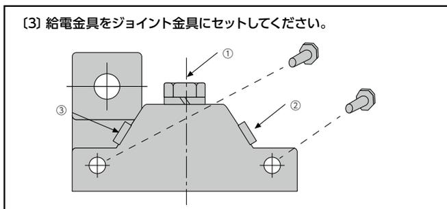
■ボルトをゆるめて導体とのレベルを合わせ、ボルトを次の順で締付けてください。(②→③→①)
