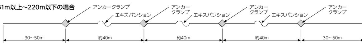
■ラインの長さが100mを超える時は、中央部にエキスパンションを設置し、その両側にアンカークランプを取付けてください。
