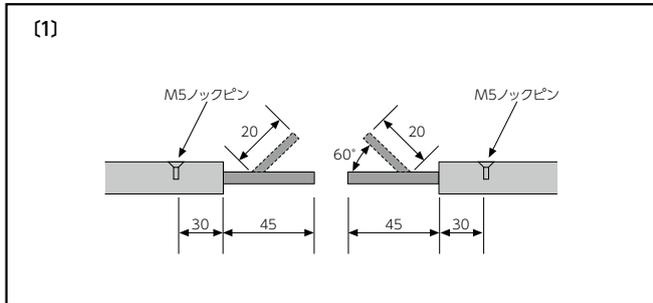
■本体の絶縁被覆を先端より45mm切断し、先端より20mmの位置で60°折曲げてください。
