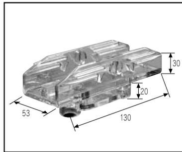
ブラシホルダーはポリカーボネイトを使用しており、化学薬品、有機溶剤、接着剤、切削油、オイル等が付着するか、これらの雰囲気の中で使用すると破損する恐れがありますのでご注意ください。
