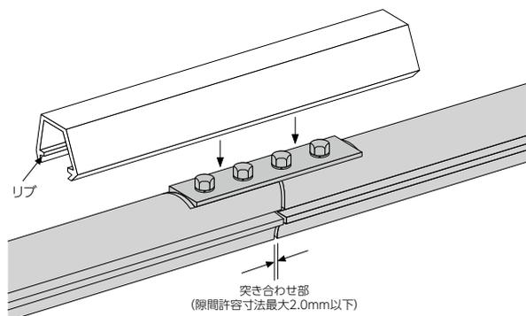
■ジョイントカバー内部のリップが本体の溝にはまり込むように押し込みます。このとき、開口部側からみてジョイントの両側の開口溝がずれたり、ねじれたりせず、まっすぐになっていることを確認してください。
