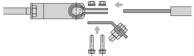
■穴開けした導体を引留金具の導体で挟み込み、給電端子とあわせてM6ボルトで締め付けます。
