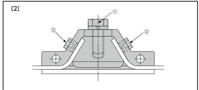
■ジョイント金具の①・②・③のボルトをゆるめて本体を取付けてください。(ボルトはゆるめておいてください。)
