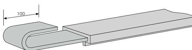
■導体を先端から100mmの位置でU字型に折曲げてください。
