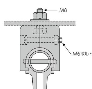
■もう片方の部品を取付けて、M6ボルトで締付けます。
